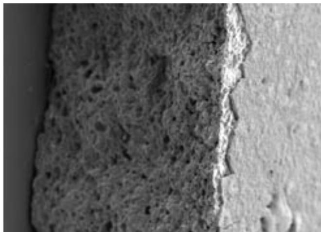
Figura 1: Fotografía SEM de la sección transversal de la membrana compuesta MC.
